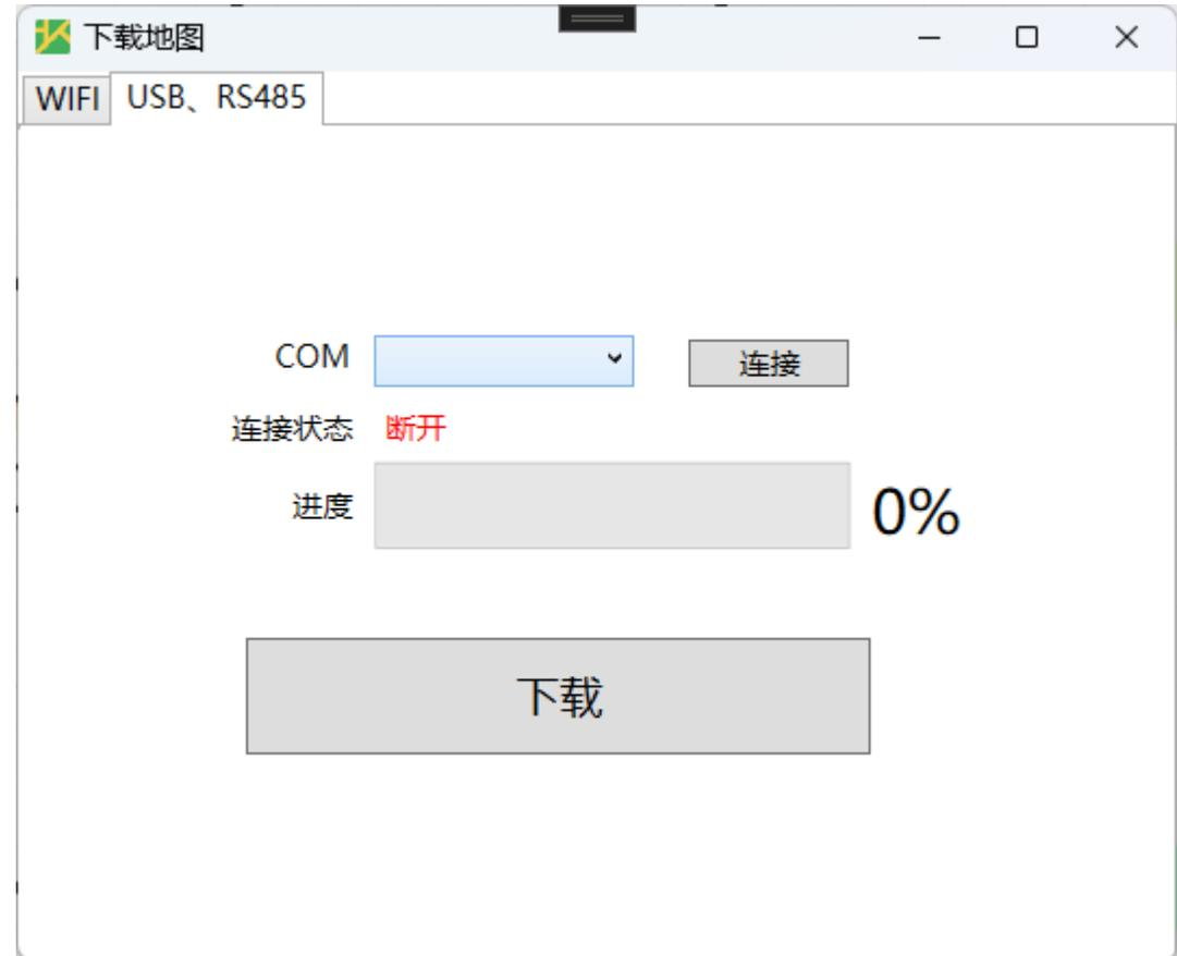
第一次使用建议用AGV控制器自带的Type-C口直接连电脑，在下载界面选择【USB、RS485】，然后选择对应的COM口，点击连，再点击下载；
