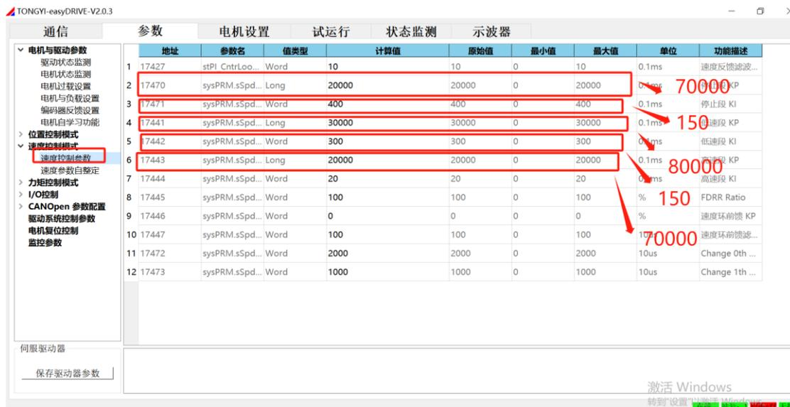
关于位置式发送的数据意义解释: 同毅内部自定, 转一圈是 65536, 跟编码器的线数无关。
