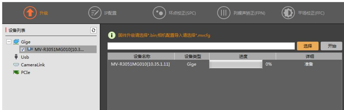
4. 再点击右侧“选择”，找到需要升级的固件程序存放位置，双击选择，最后点击“开始”进行升级，界面会实时显示升级进度，最后“升级成功”后，断电重新相机即可完成升级工作。
