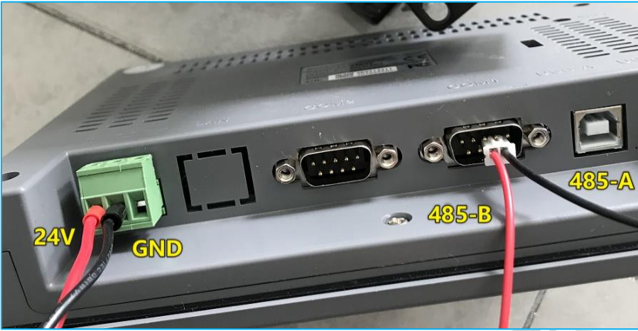
图 5-1 触摸屏款式一实物接线
