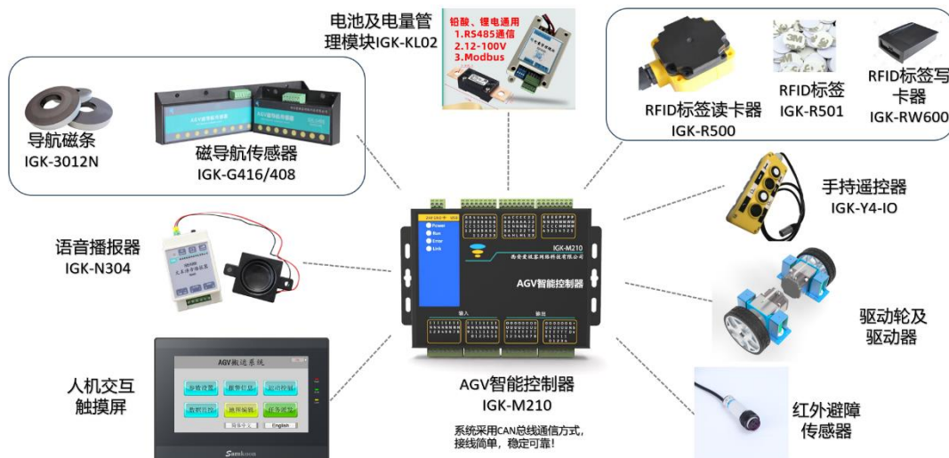
图 1-1 IGK 双轮差速二维码 AGV 系统组成
