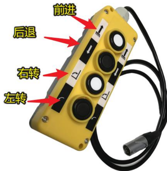
图 6-3 手动模式下的遥控器按键功能
